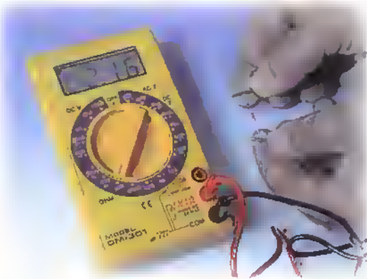
Figura 3.16. Medida de una resistencia de 2.200 \Omega
